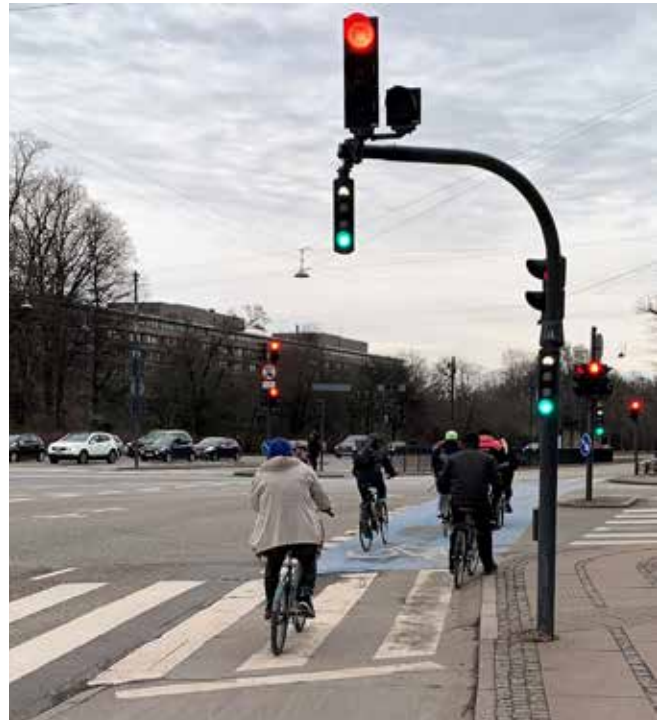
Førgrønt for cyklister samt slukket eftergrønt højresvingsspil for bilister, Tagensvej/Nørre Allé
