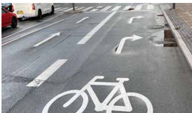
Det sidste cykelsymbol før krydset placeres, hvor den punkterede kantlinje ophører
