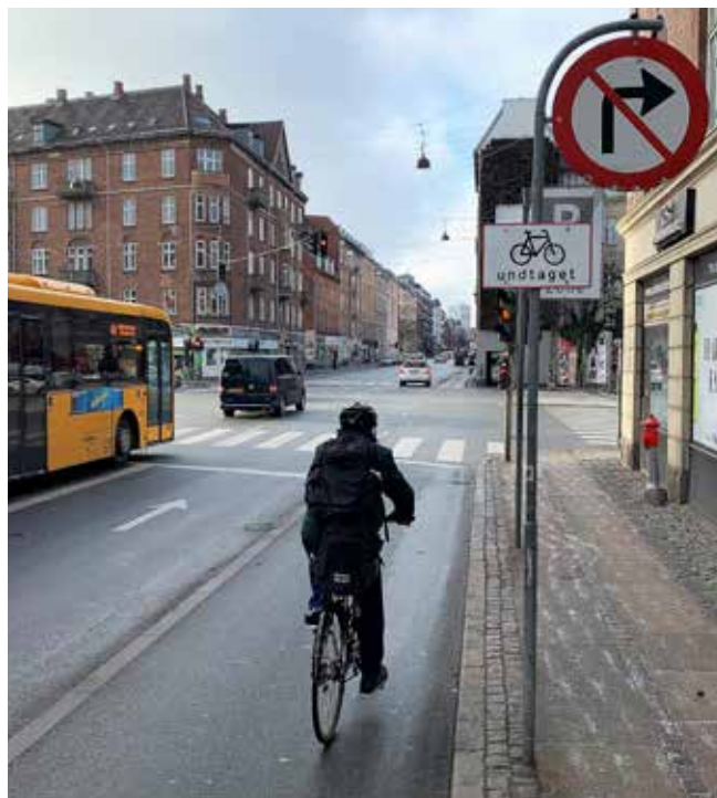
Fremført cykelsti og højresvingsforbud for bilister, Jagtvej/Ågade
