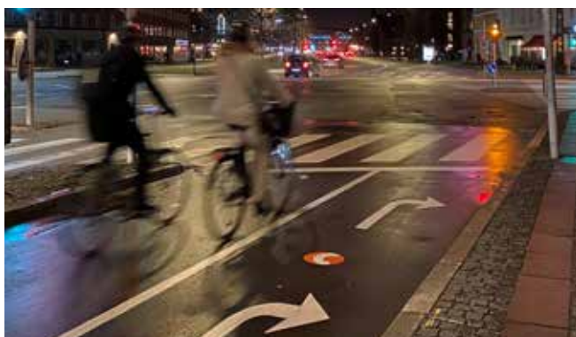
Højresvingspil og supercykelsti afmærkning på cykelstien på H.C. Andersens Boulevard/Nørre Farimagsgade
