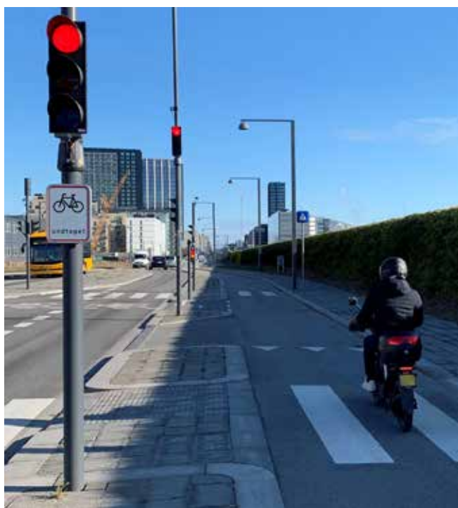
Tilladt ligeudkørsel for rødt i T-kryds, Ørestads Boulevard/Ejler Billes Allé
