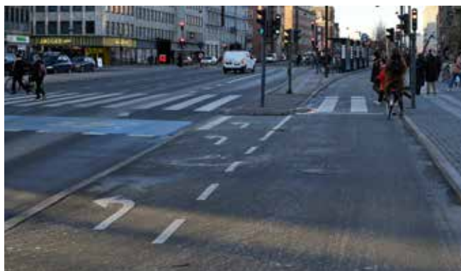
Venstresvingsbane og bred ligeudbane i T-kryds, H.C. Andersens Boulevard/Vesterbrogade
